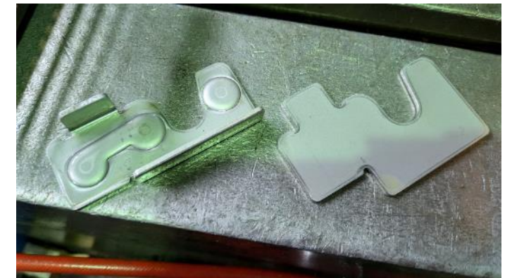
▲加工前(右)とプレス機による加工後(左)の違い
